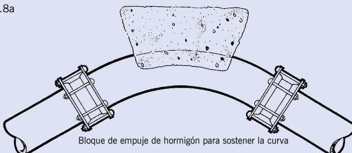
Bloque de empuje de hormigón para sostener la curva
